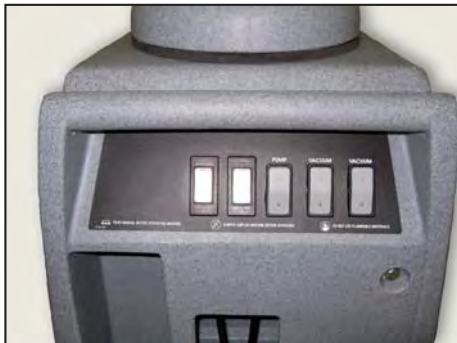
Zwei Stromkreise - Pumpe und Turbine, Turbine.
